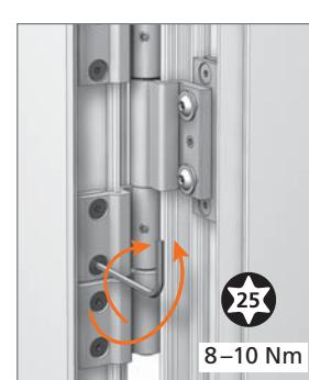
Die rahmenseitigen Befestigungsschrauben aller Bandteile festziehen und das Höhenverstellset durch das Lösen der Klemmsteine aus der Rahmennut entfernen.
