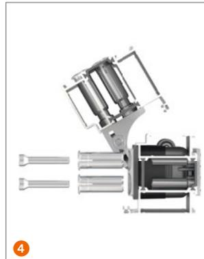
Прижимать распорную втулку винтами до прилегания буртика к профилю. Когда буртик втулки находится на профиле, проворачивать шестигранник, пока трижды не почувствуете легкое сопротивление. Это означает, что петля зафиксирована.
