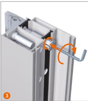
Прижать винтом распорную втулку до прилегания буртика к профилю.
