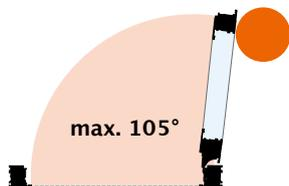
**Обязательна установка напольного ограничителя открывания. Отсутствие напольного ограничителя открывания приводит к разрушению петель.**
