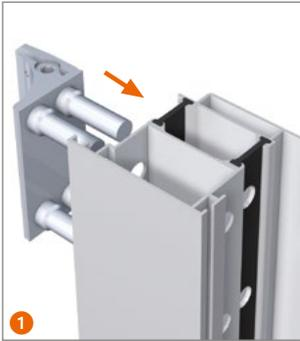
Вставить створочную часть петли в створочный профиль согласно рисунку.
