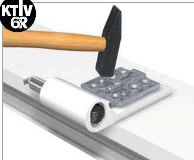
**Вставить створочную часть петли в просверленые отверстия**
