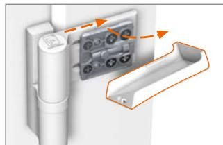
**Регулировка по горизонтали**
